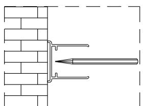
Sätt väggprofilen mot väggen och måttar in den. Markera skruvhålen på väggen.
