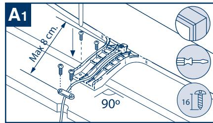
Sistema de enganche a madera / Attachment to wood / Système d'accrochage sur panneau miroir / Система крепления на деревянное покрытие
