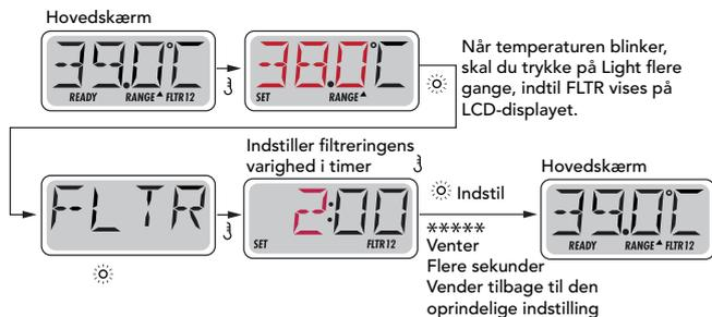
Hvis Filtercyklus 2 er aktiveret, vises Filter 12 på LCD-displayet. Hvis filteret er deaktiveret, vises Filter 1.
