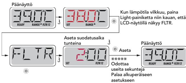
Jos Suodatinjakso 2 on aktivoitu, LCD-näytössä näkyy Filter 12. Jos suodatin ei ole käytössä, näytössä näkyy Filter 1.
