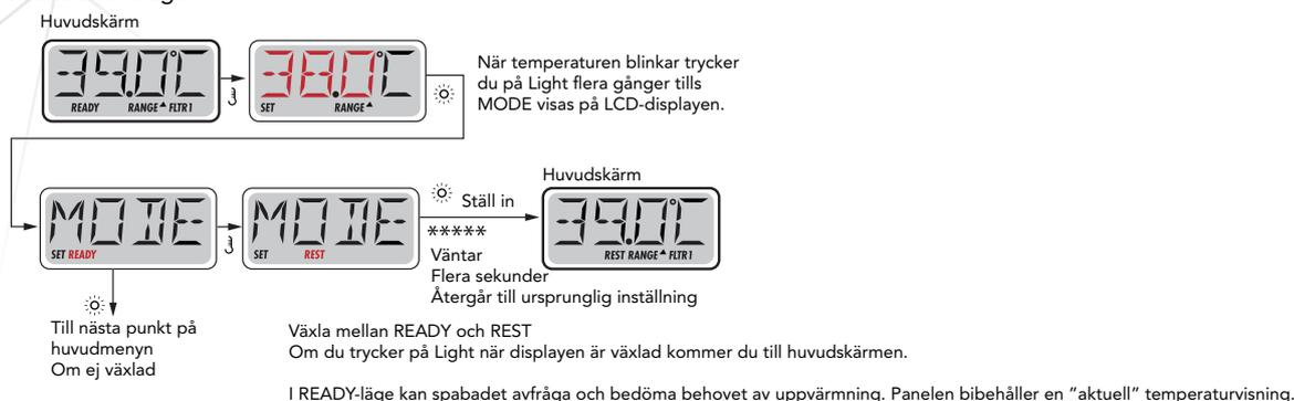
REST-läge avfrågar inte och uppvärmning körs endast under filtercykler. Panelen visar inte alltid aktuell temperatur.
