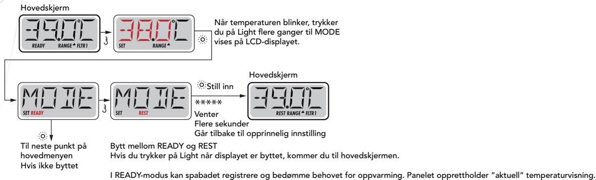
REST-modus registrerer ikke, og oppvarming kjøres kun under filtersykluser. Panelet viser ikke alltid aktuell temperatur.
