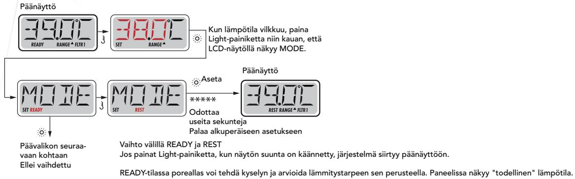
REST-tilassa lämpötilaa ei kysytä, ja lämmitys tapahtuu ainoastaan suodatusjaksojen aikana. Todellinen lämpötila ei näy paneelissa koko aikaa.
